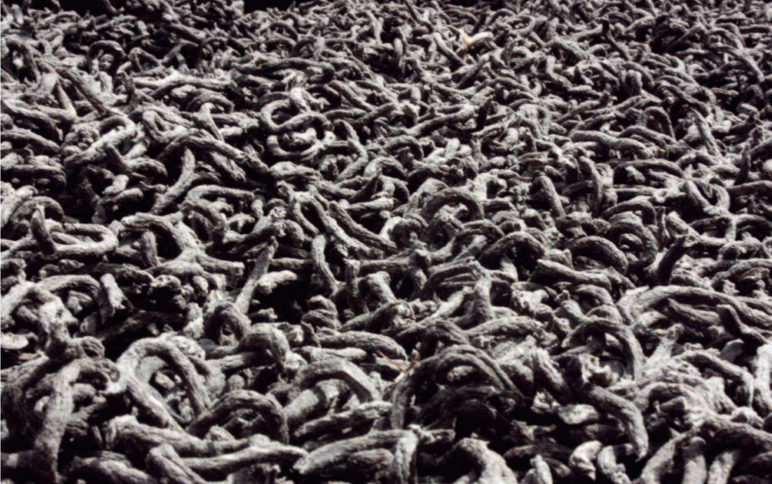
Slampelletts från slamtorken på reningsverket i Mora.
